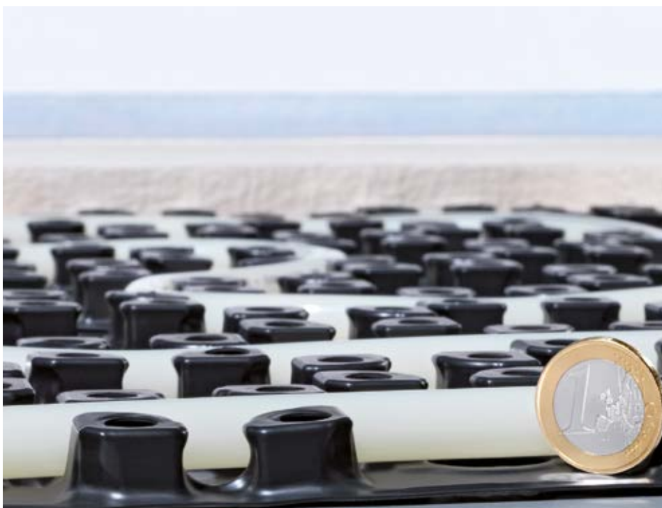
Das neue Prineto Dünnschicht-Fußbodenheizsystem ist für die Sanierung in Gebäuden mit niedriger Raumhöhe konzipiert. Zusammen mit dem Nivellierestrich baut das System ab Unterkante Noppenplatte nur 22 mm auf.
